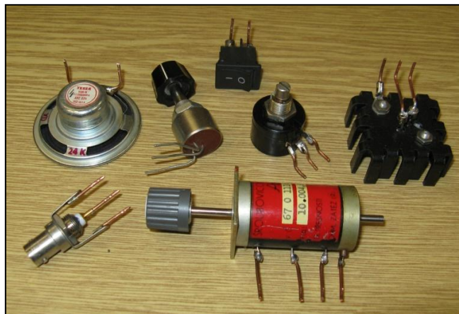
Větší součástky jsou opatřeny silnějšími vývody
