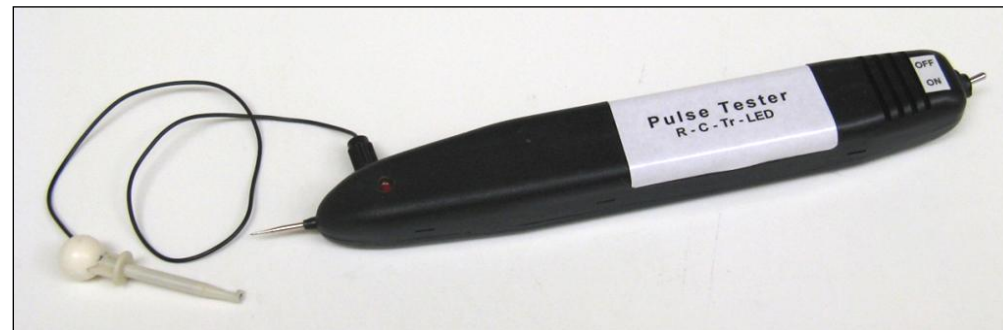
Impulzní zkoušečka zabudovaná do krabičky od nepotřebné TTL zkoušečky
